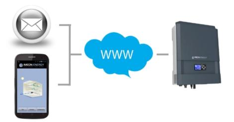
Pour communiquer avec l'IMEON, il faut simplement installer la carte de communication IMEON WEBCARD dans le slot de communication de l'IMEON. L'installation est simple et rapide : Branchement de la carte, puis configuration du réseau sur la Box internet.
