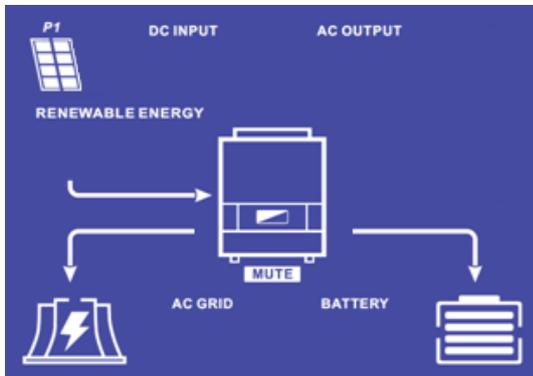
La production photovoltaïque permet de recharger le parc batteries et d'injecter l'excédent d'énergie sur le réseau public.
