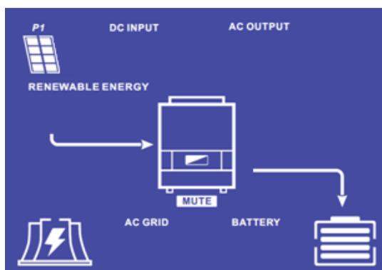
L'icône « AC GRID » clignote, le réseau n'est pas connecté à l'IMEON.
