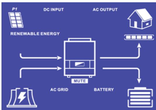
La production photovoltaïque permet d'alimenter les consommateurs et de recharger le parc batteries. Le réseau apporte les besoins supplémentaires pour recharger le parc batteries.
