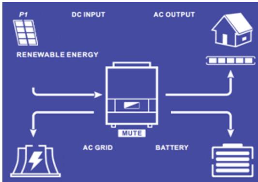
La production photovoltaïque permet d'alimenter les consommateurs, de recharger le parc batteries et d'injecter l'excédent d'énergie sur le réseau public.
