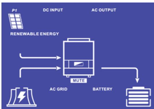
La production photovoltaïque permet de recharger le parc batteries. Le réseau apporte les besoins supplémentaires pour recharger le parc batteries.
