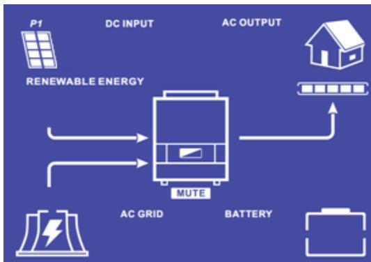
L'icône « BATTERY » clignote, le parc batteries n'est pas connecté à l'IMEON.
